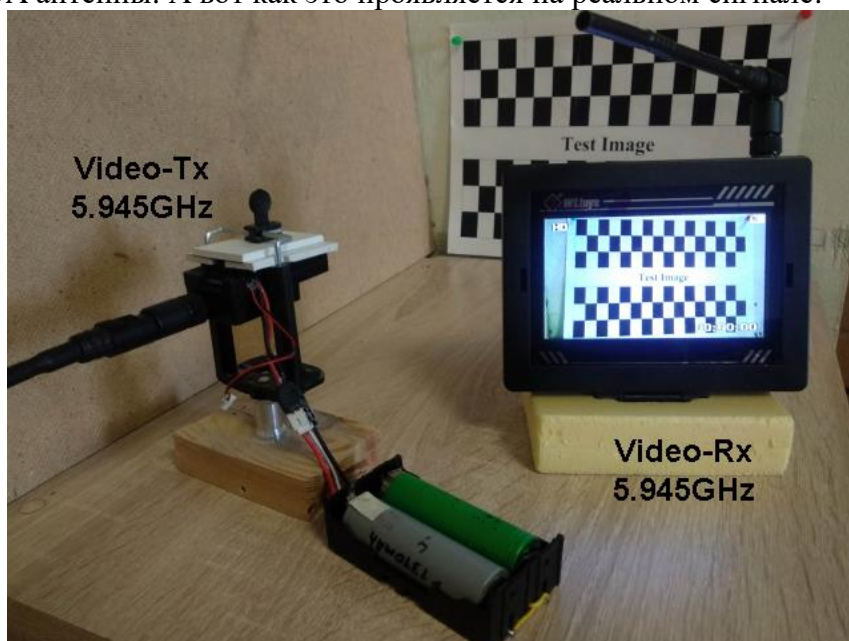
Рис.3. Аналоговый видео-сигнал частоты 5.8GHz, видео-передатчик (Video-Tx) и видео-приемник (Video-Rx) от WLtoys для тестирования LPDA антенны.
