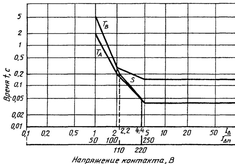
S - предельные значения, соответствующие максимальной длительности напряжения контакта до 220 В, указанной в таблице 41 ГОСТ 30331.3
