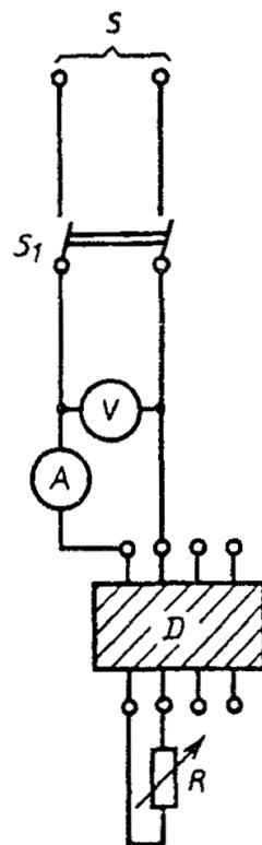
*S* - источник электрической энергии; *S<sub>1</sub>* - двухполюсный выключатель, *V* - вольтметр; *D* - испытуемое УЗО - Д; *R* - регулируемый резистор; *A* - амперметр
