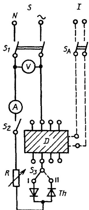
*S* - источник электрической энергии; *I* - независимая линия питания; *V* - вольтметр (показывающий истинное действующее значение); *D* - УЗО - Д, подвергаемое испытанию; *R* - регулируемый резистор; *S<sub>1</sub>* - многополюсный выключатель, *S<sub>2</sub>* - однополюсный выключатель; *S<sub>3</sub>* - двухполюсный выключатель на два направления; *S<sub>A</sub>* - вспомогательный выключатель, *Th* - тиристоры
