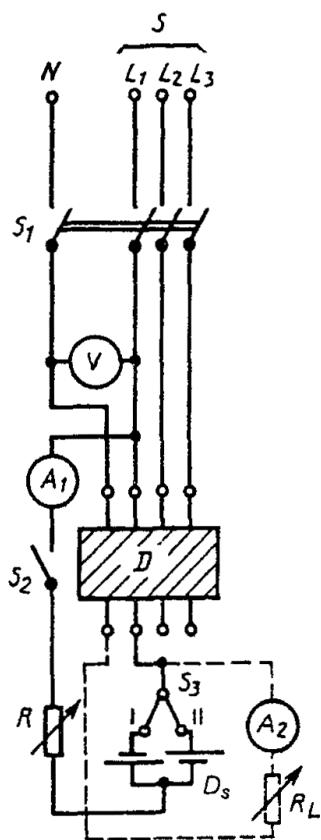
$A_1$  - амперметр постоянного тока;  $A_2$  - амперметр переменного тока;  $D$  - испытуемое УЗО -  $\Delta$ ;  $D_s$  - источник постоянного тока;  $R$  - регулируемый резистор;  $R_L$  - активная нагрузка;  $S$  - источник питания переменного тока;  $S_1$  - многополюсный выключатель;  $S_2$  - однополюсный выключатель;  $S_3$  - двухполюсный выключатель на два направления;  $V$  - вольтметр
