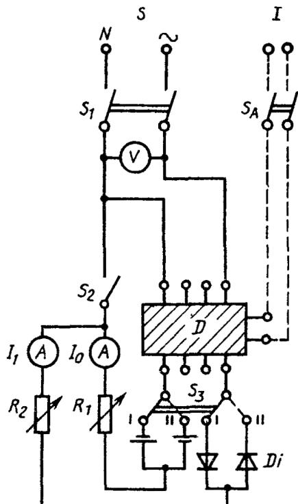
*S* - источник электрической энергии; *I* - независимая линия питания; *V* - вольтметр; *A* - амперметр; *D* - УЗО - Д, подвергаемое испытанию; *Di* - диоды; *R<sub>1</sub>* и *R<sub>2</sub>* - регулируемые резисторы, *S<sub>1</sub>* - многополюсный выключатель; *S<sub>2</sub>* - однополюсный выключатель, *S<sub>3</sub>* - двухполюсный выключатель на два направления; *S<sub>A</sub>* - вспомогательный выключатель
