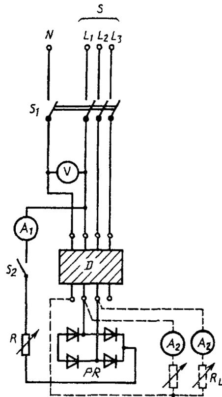
$A_1$  - амперметр действующих значений;  $A_2$  - амперметр переменного тока;  $D$  - испытуемое УЗО - Д;  $PR$  - двухполупериодная мостовая схема на линейном напряжении;  $R$  - регулируемый резистор для дифференциального тока;  $R_L$  - активная нагрузка;  $S$  - источник переменного тока;  $S_1$  - многополюсный выключатель;  $S_2$  - однополюсный выключатель;  $V$  - вольтметр
