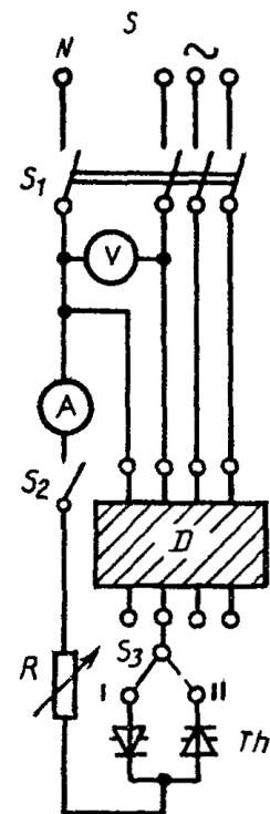
Рисунок 3д - Схема испытательной цепи для проверки правильности отключения УЗО - Д с вспомогательным источником питания, представляющим собой главную линию питания, в случае дифференциального тока с пульсирующей постоянной составляющей
