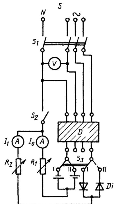
Рисунок 3f - Схема испытательной цепи для проверки правильности отключения УЗО - Д с вспомогательным источником питания, представляющим собой главную линию питания, в случае дифференциального тока со стабилизированной постоянной составляющей
