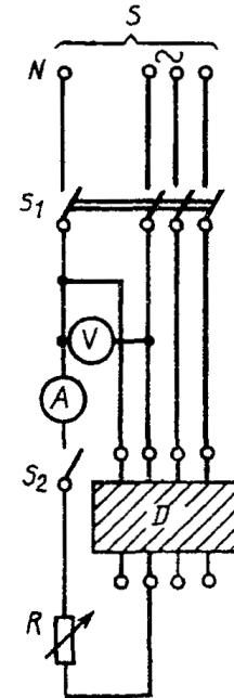
*S* - источник электрической энергии; *I* - независимая линия электропитания; *V* - вольтметр; *A* - амперметр;
