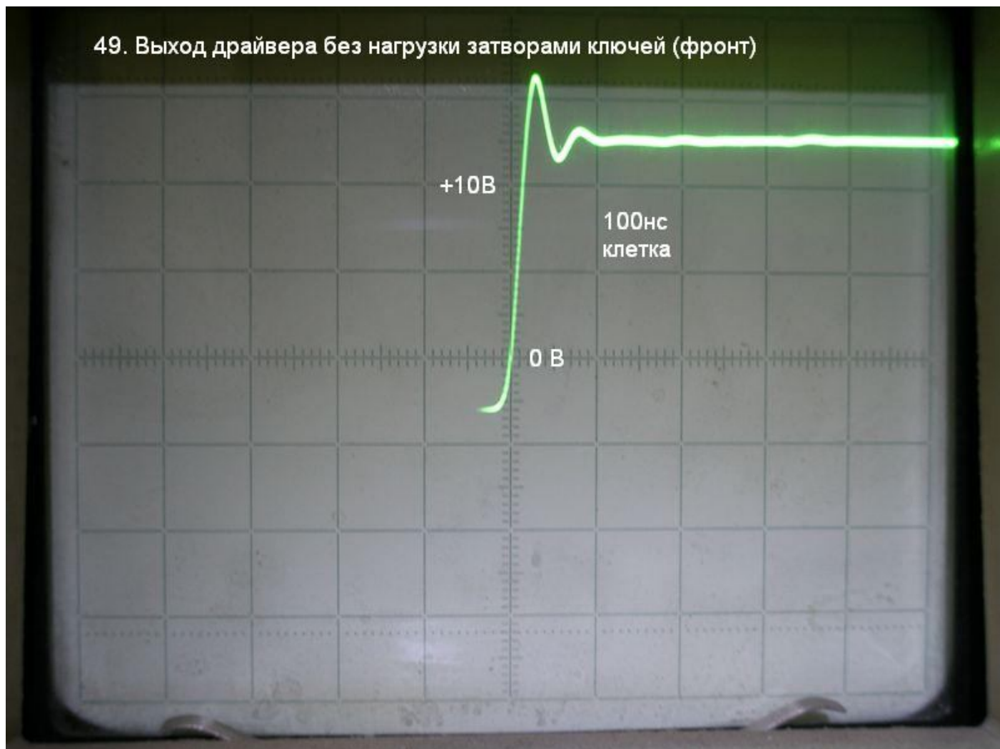
50. Выход драйвера без нагрузки затворами ключей (фронт)
